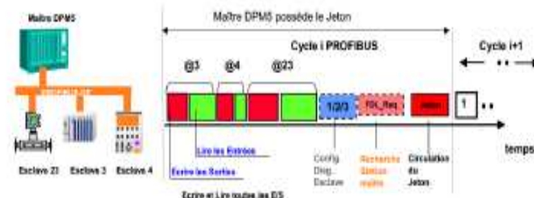
Figure12 : Trame d'échange cyclique
