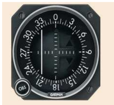
FIGURE 19:AVION A DROITE DE L'AXE DE PISTE
