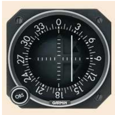
FIGURE 18:AVION A GAUCHE DE L'AXE DE PISTE
