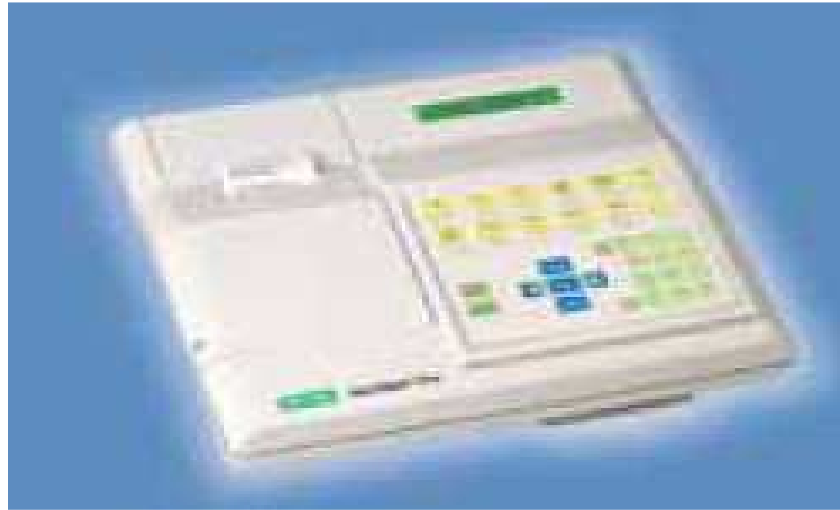
Figure. 2 : Spectrophotomètre : SmartSpec Plus spectrophotometerBioRad
