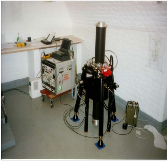
Figure 7. Gravimètre Absolu balistique FG5 –a- et A10 –b-.
