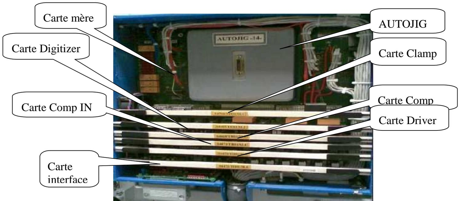
Figure 12 : Cartes électroniques du Test-Head
