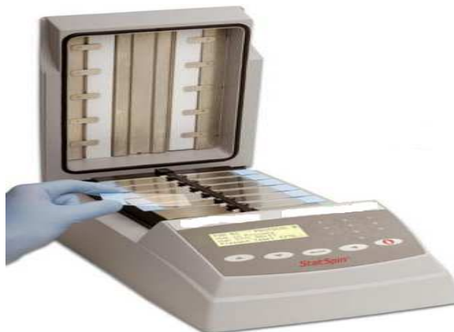
Figure 14 : Thermobrite utilisé pour l'hybridation des sondes avec leur locus spécifique
