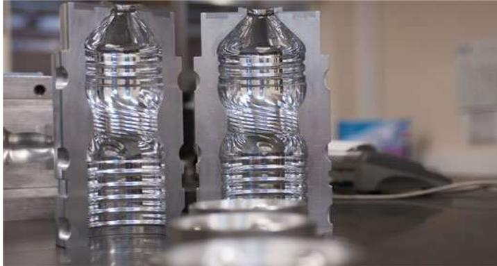
**Figure 6 : un moule d'une bouteille de 1L**
