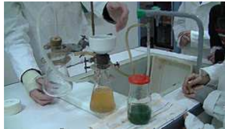
Figure 9 : technique de la membrane filtrante
