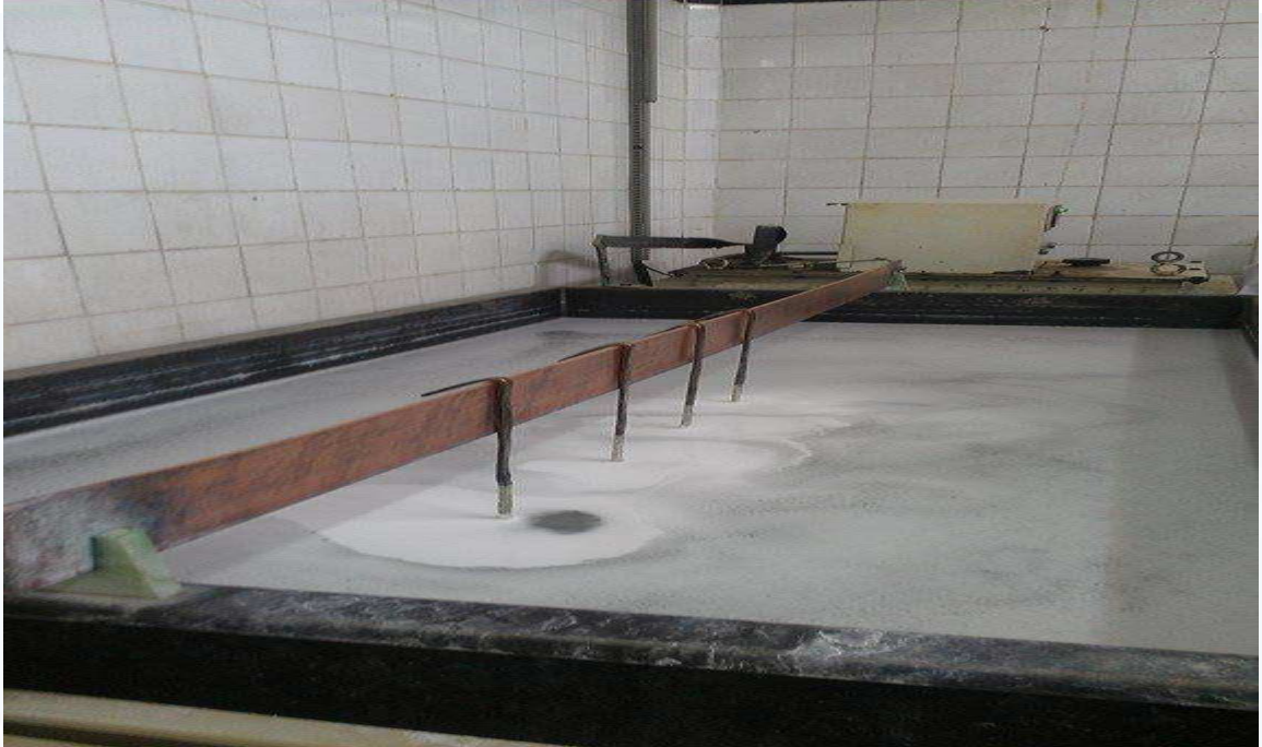
Figure N° 7 : bain de dégraissage
