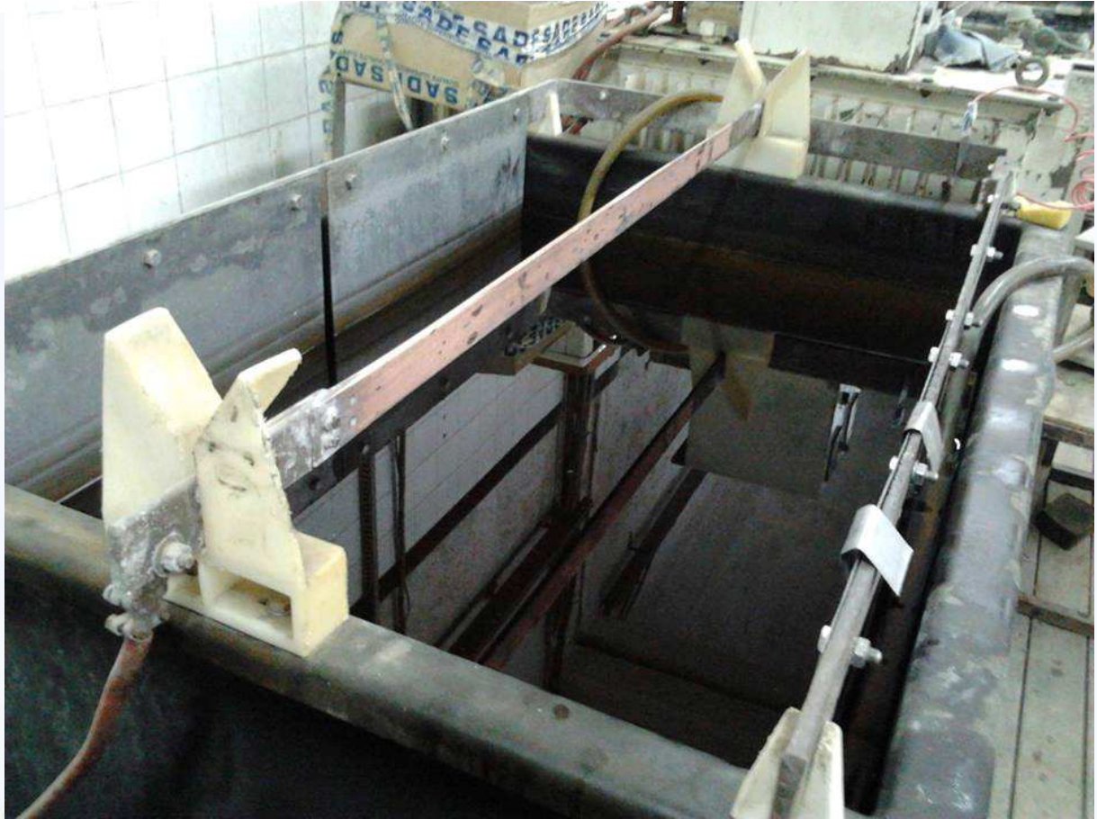
Figure N° 12 : bain de pré-argentage
