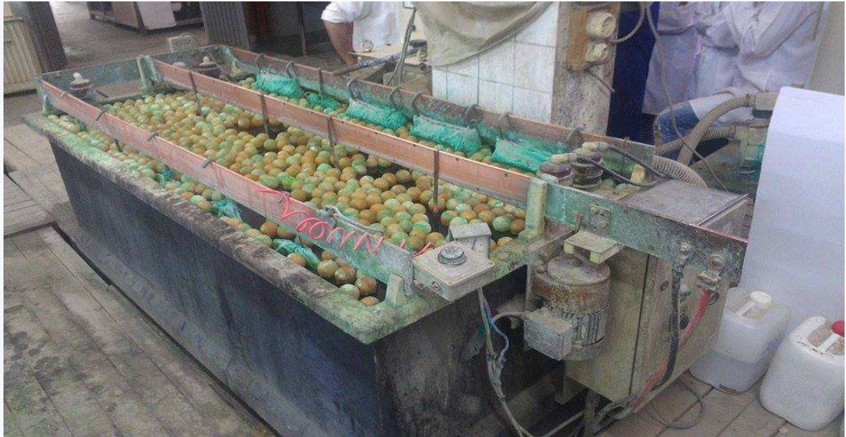
Figure N°11 : bain de nickelage
