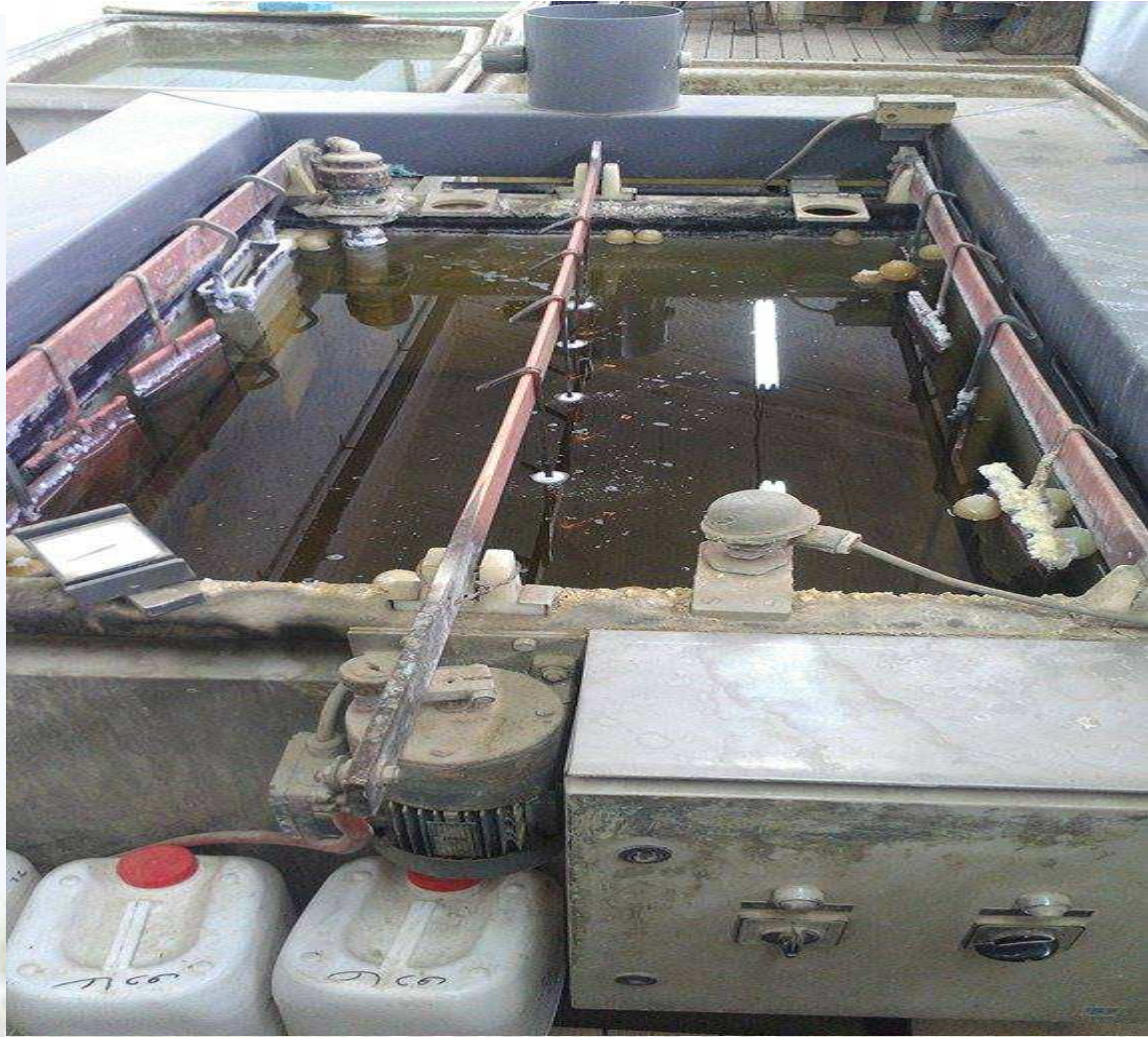
Figure N°9 : bain de cuivre alcalin
