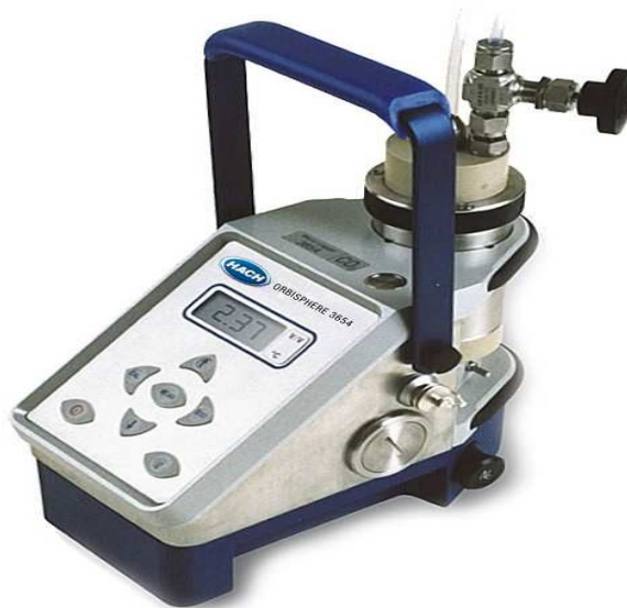
Figure 2 : appareil de mesure du taux d'oxygène dissous dans la bière « orbisphère »
