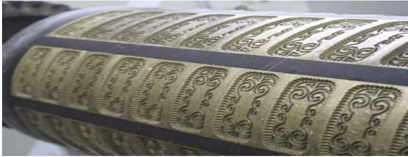
Figure 1 : Photo de cylindre de moulage des biscuits
