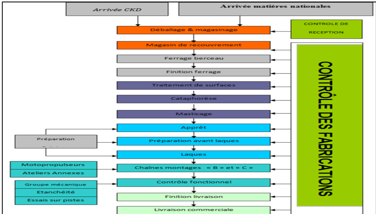
Figure 8: Le processus complet de fabrication à SOMACA
