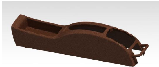
Figure 48:protecteur de la console de frein à main conçu sous CATIA V5
