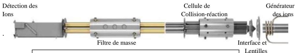
Figure 8 : ICP-MS quadripolaire avec cellule collision-réaction
