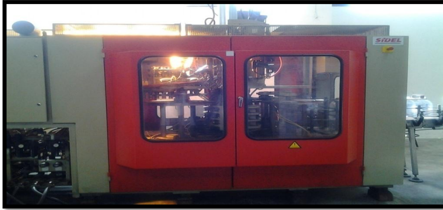
Figure 6 : SIDEL la machine qui réalise le soufflage
