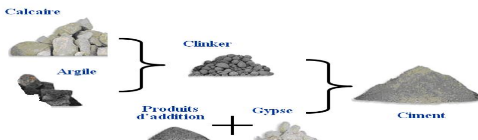
Figure 1: Les différents constituants entrant dans la fabrication du ciment Portland
