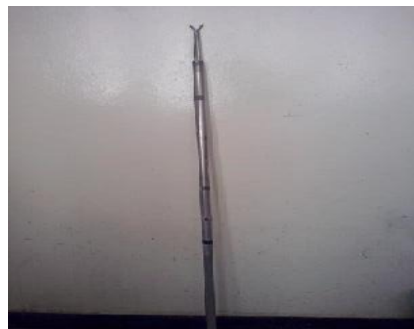
Figure 26 : image de tube de Pitot utilisé dans la mesure de la pression dynamique de l'air
