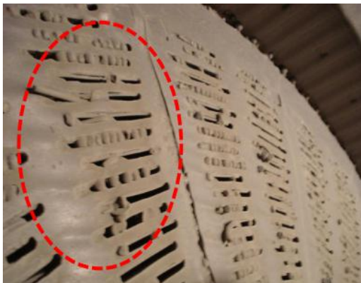
Figure 18 : à gauche : image de la ferraille dans les lumières du diaphragme intermédiaire
