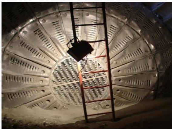
Figure 16 : image de l'état du diaphragme intermédiaire
