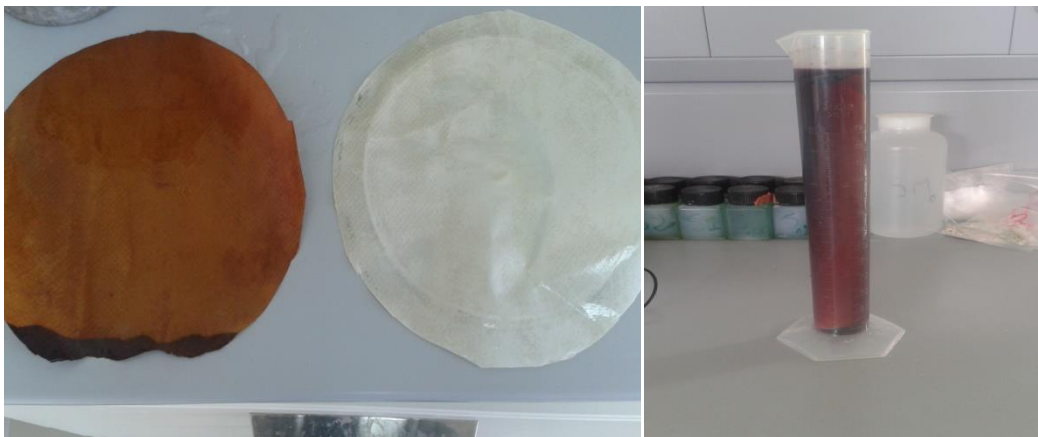
Figure 12: membrane apres et avant recyclage par \text{KMnO}_4
