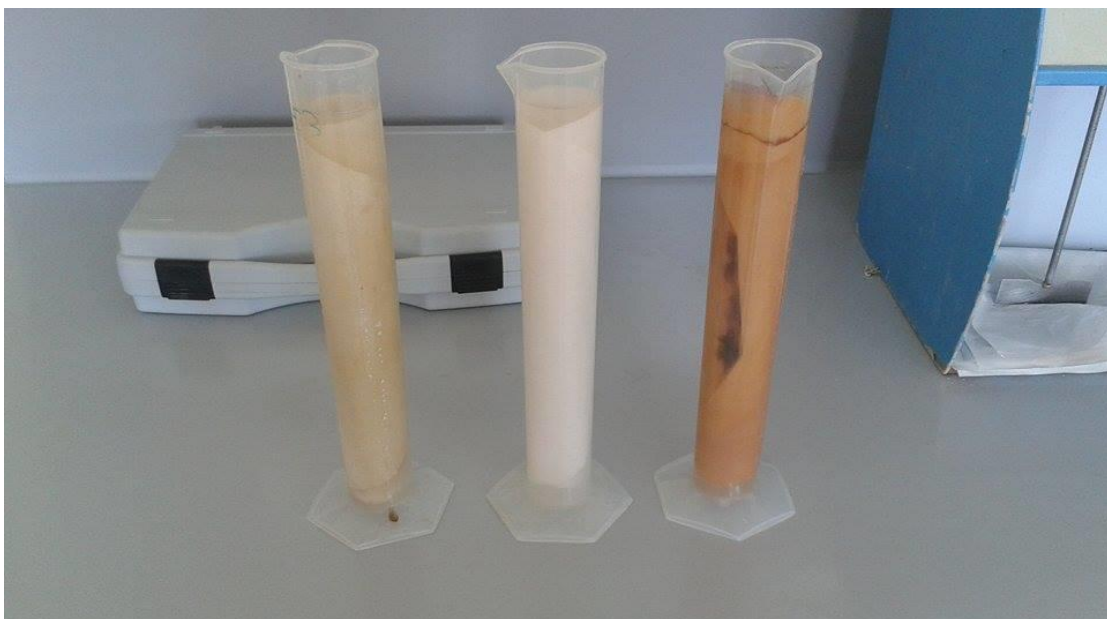
Figure 14: membranes OI immergées dans les oxydants
