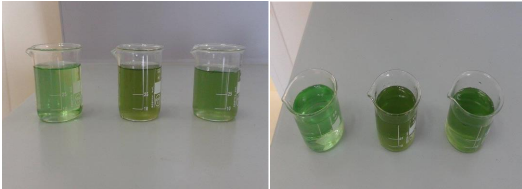
Figure 13: acide clarifier par membranes recyclées par \text{KMnO}_4
