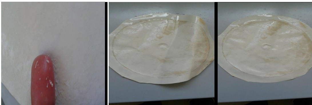
Figure 16: dégradation de la membrane recyclée par NaOH
