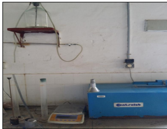
Figure 5 : Appareillage de l'essai d'équivalent de sable
