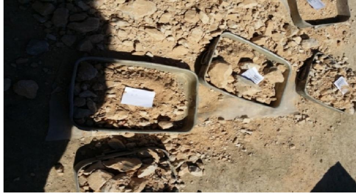
Figure 14 : Répartition de l'échantillon sur des divers bacs
