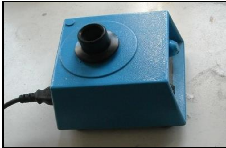
Figure I.22 : Agitation du mélange à l'aide d'un agitateur vortex.
