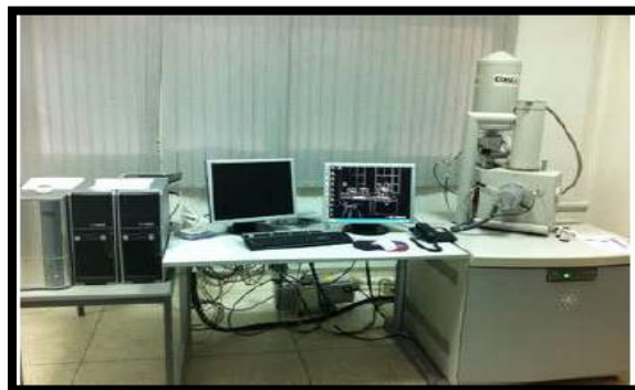
Figure.5 : Microscope Electronique à Balayage Environnemental (FEI, compagnie)
