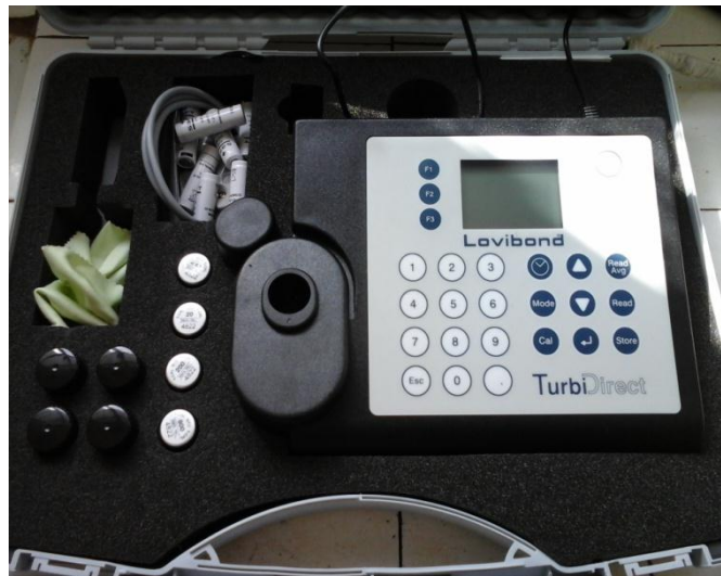
Photo 7 : Turbidimètre, Unité : NTU
