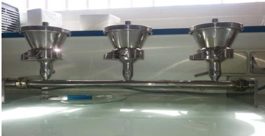
Photo 1 : Rampe de filtration trois poste
