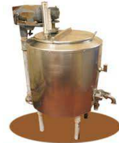
Figure 7 : Cuve de préparation des sels
