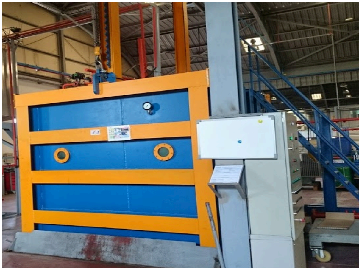
Figure 9 : Photo du caisson de remplissage sous vide
