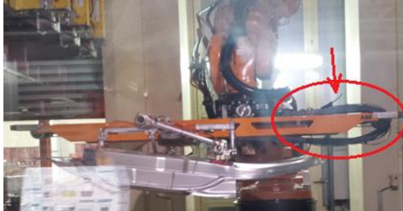
Figure 27 : Dégradation de la ceinture du 7 ème axe
