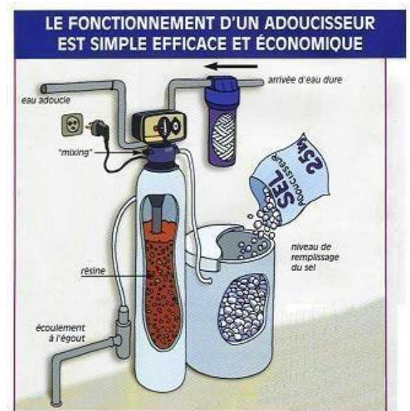
Figure 3 : le fonctionnement d'un adoucisseur
