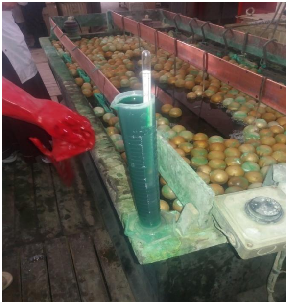
Image 22 : Mesure de concentration
