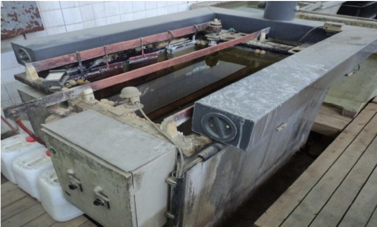
Image 16 : Bain de cuivrage alcalin
