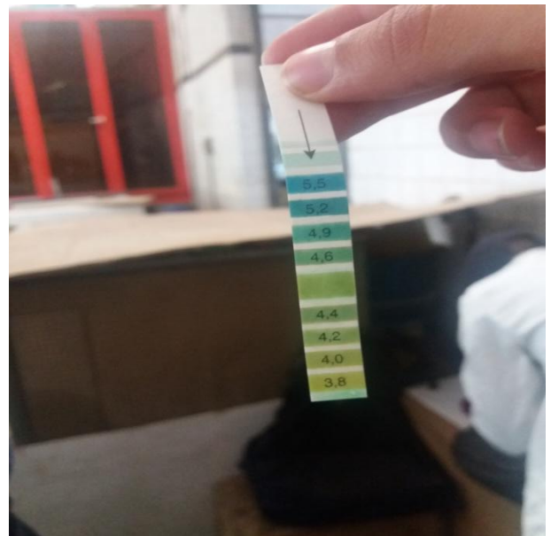
Image 23 : Mesure de pH
