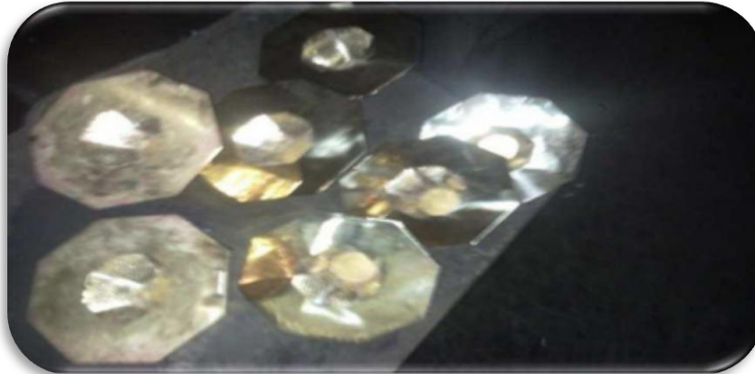
Image 9 : Comparaison des articles polies et non polies
