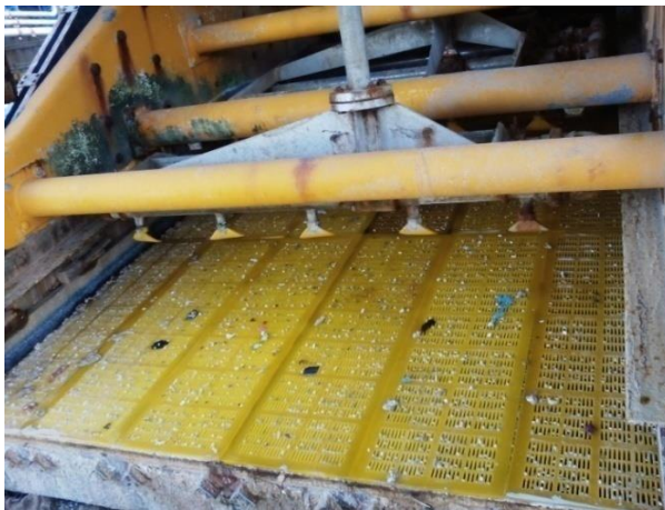
Figure 5 : phénomené de goujonnage
