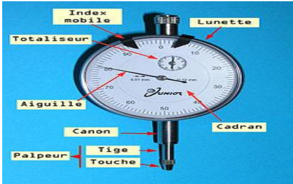
Figure 14 : Comparateur à cadran
