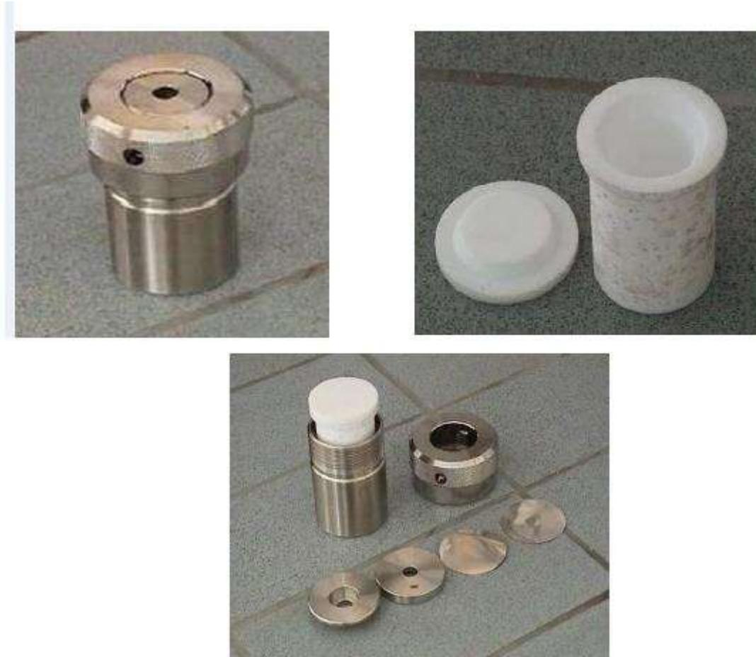
**Figure 20 :** Dispositif de l'autoclave utilisé dans la méthode hydrothermale.
