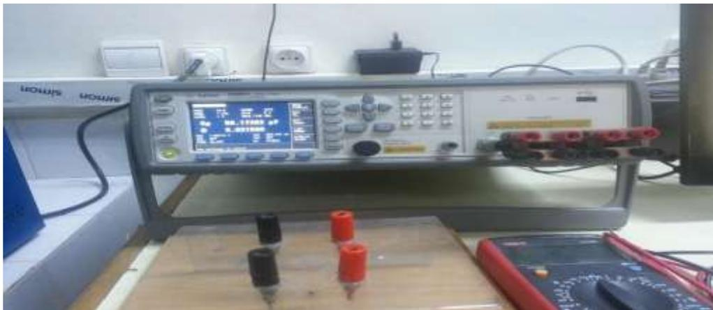
**Figure 34** : l'appareil utilisé pour les mesures diélectriques
