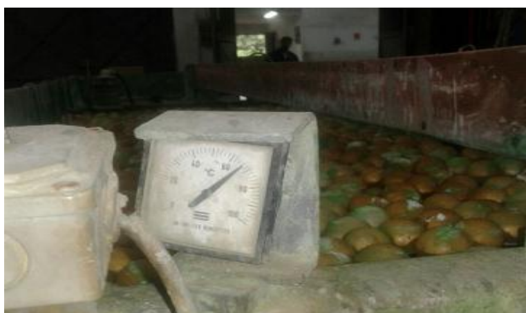
Photo 10 : thermomètre du bain de nickel
