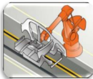
Assemblage des cotes de caisse
