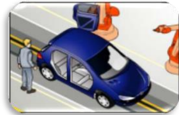
Montage des portes
