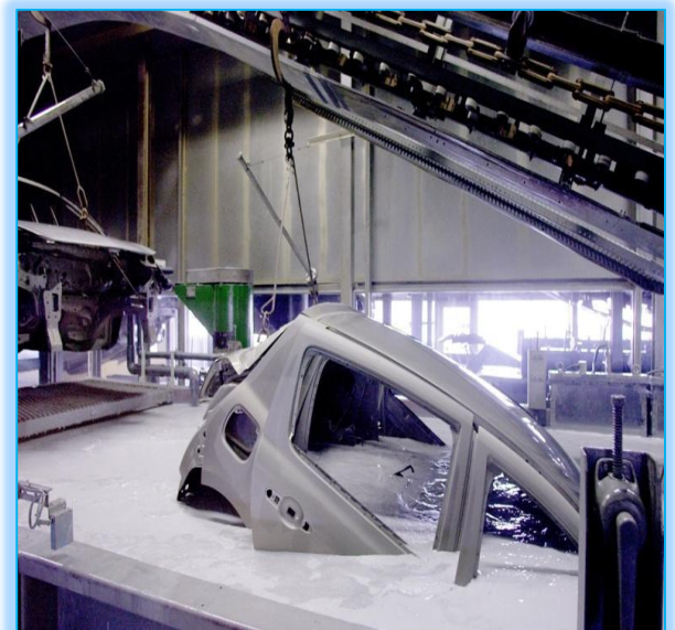
Figure I-13: Image de l'engagement des caisses dans le bain
