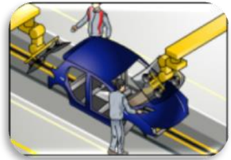
Pose du bard-brise
