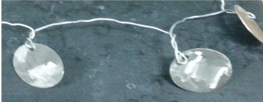
Figure III-10 : Image de fixation des plaques d'acier inoxydables au cours de l'électrodéposition
