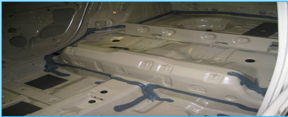
Figure I-14 : Image de l'opération de masticage
