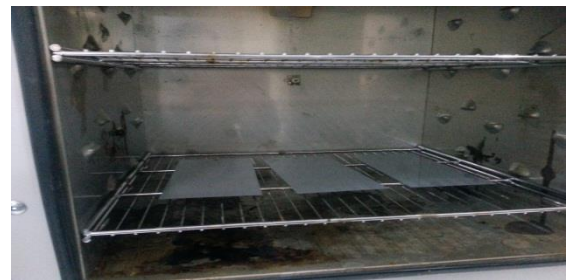
Figure III-3 : Image du séchage des éprouvettes dans l'étuve
