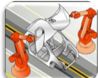
Assemblage de la caisse
