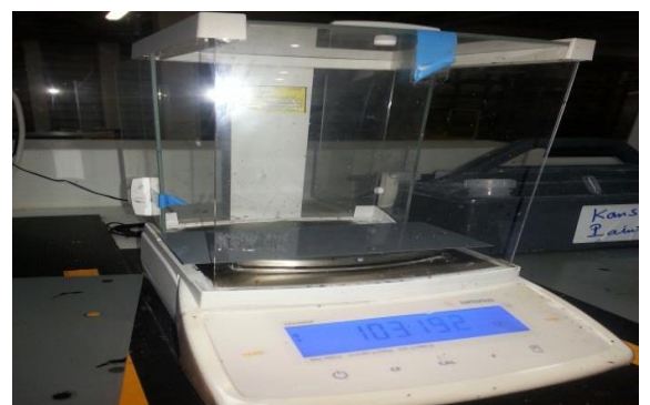
Figure III-4 : Image du pesage des éprouvettes
