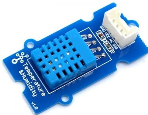
Figure 10: Capteur température et d'humidité
