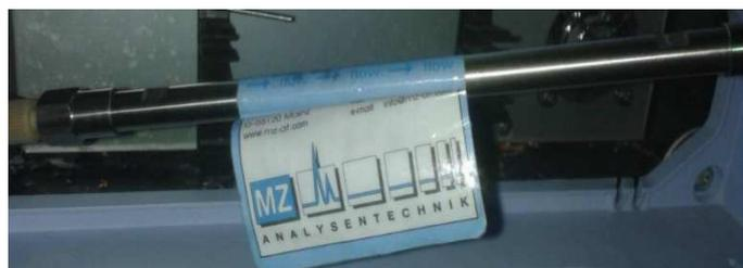
**Figure 4: Une colonne HPLC**
