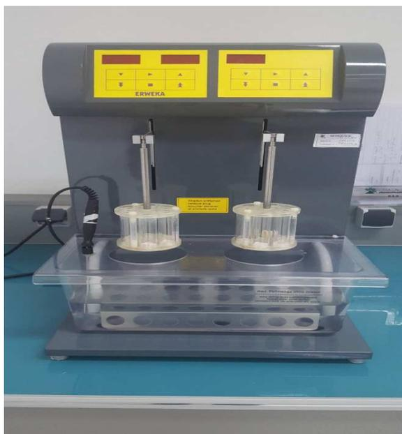
Figure 6: Appareil de désagrégation « ERWEKA »
