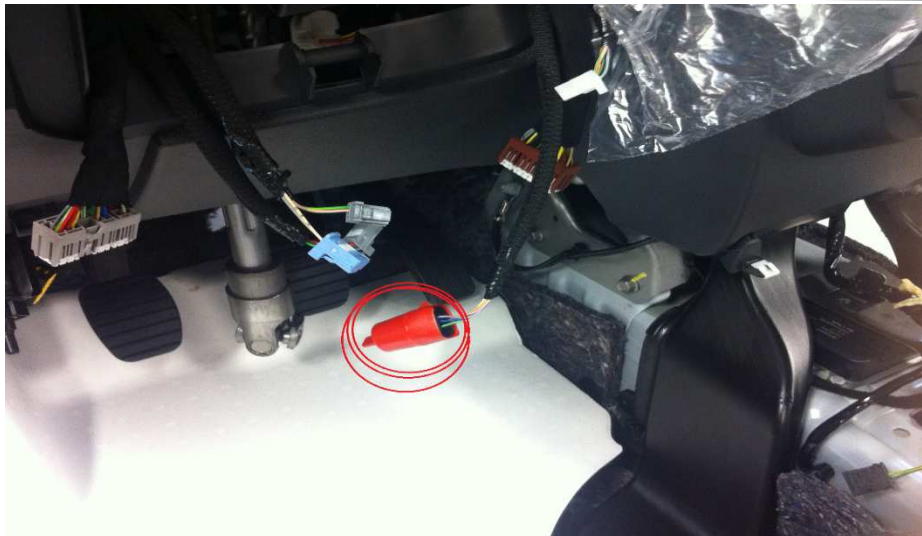
Figure 45: le connecteur après insertion du bouchon
