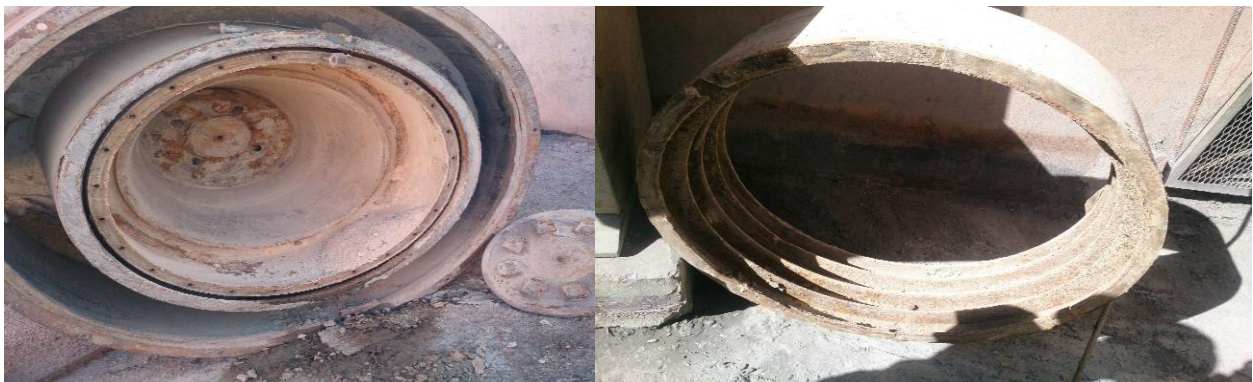
Figure IV-7 : Photos de Démontage du bol du concentrateur
