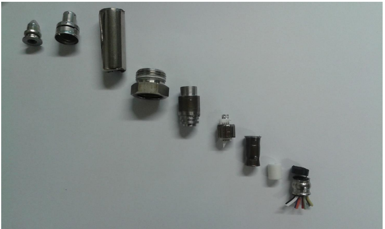
Figure : Structure d'une sonde lambda au dioxyde de zirconium, société NGK.
