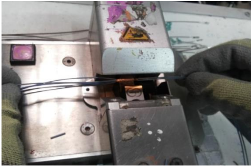
Figure 84 : Soudage des extrémités des fils par l'US.
