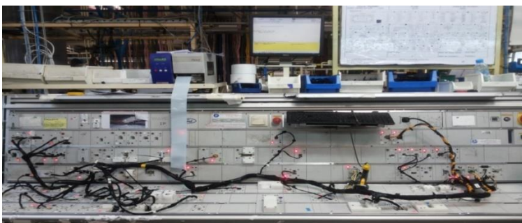
Figure 33 : Banc du test électrique.
