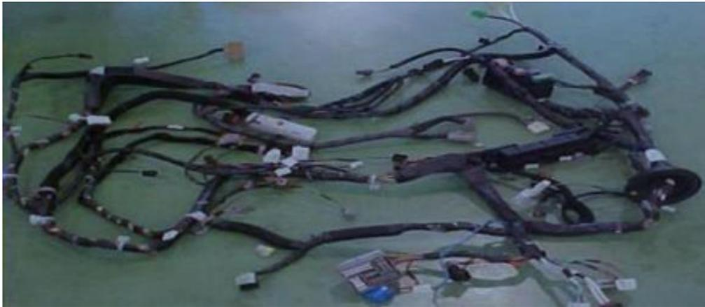
Figure 7: Faisceau électrique fini
