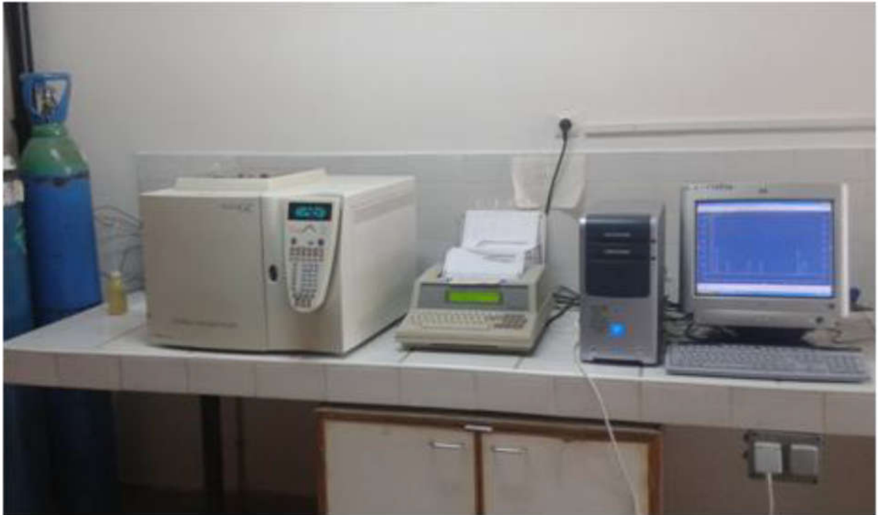
Figure 7: Chromatographe en phase gazeuse couplée à un détecteur à ionisation de flamme et un détecteur olfactif (GC-FID-O).
