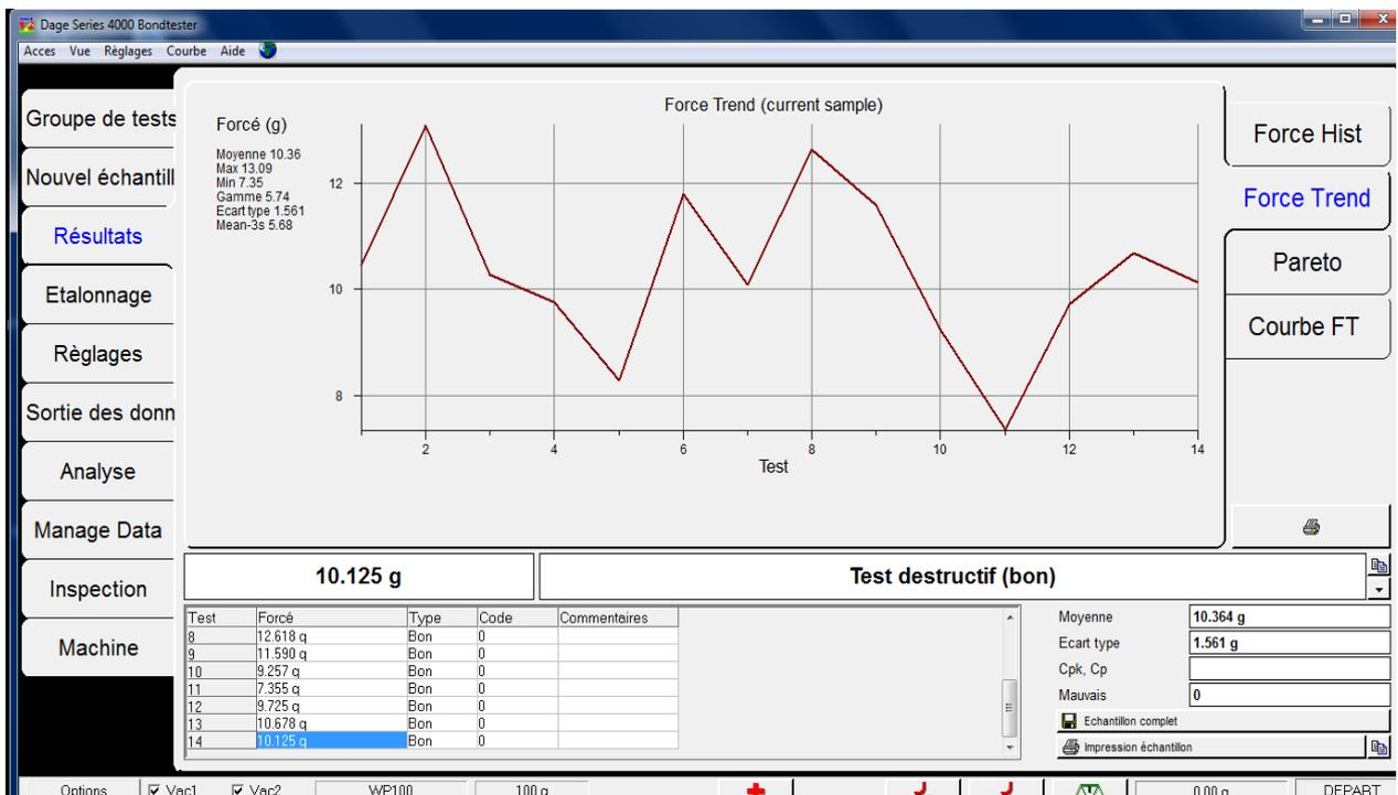
Figure 21 : l'interface principale du logiciel de la machine Dage.
