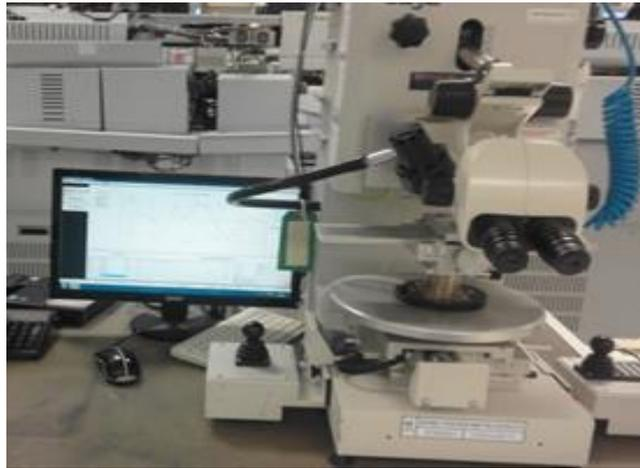
Figure 13 : La machine Dage 4000
