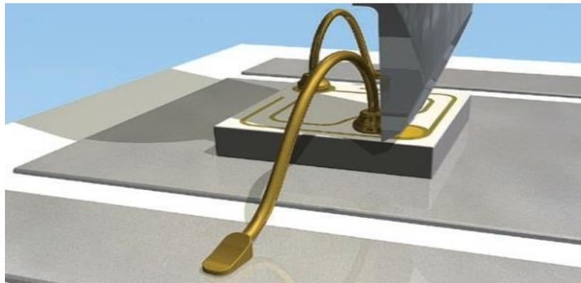
Figure 25 : Ball Shear
