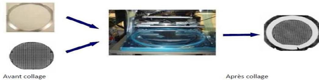
Figure 4 : Opération de collage de la plaquette
