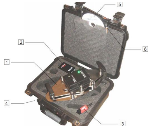
Figure 42 : Les composants du système de suivi d'ovalisation
