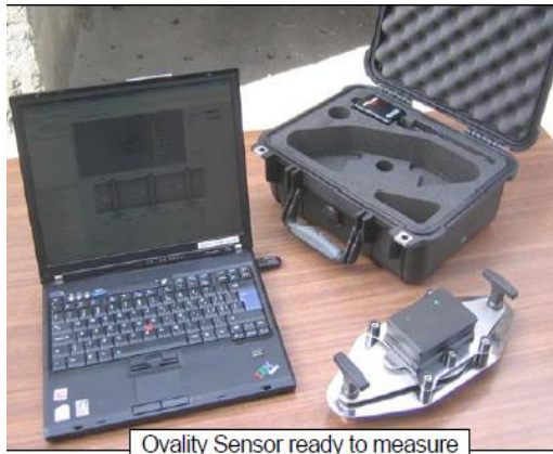
Figure 42 : Les composants du système de suivi d'ovalisation
