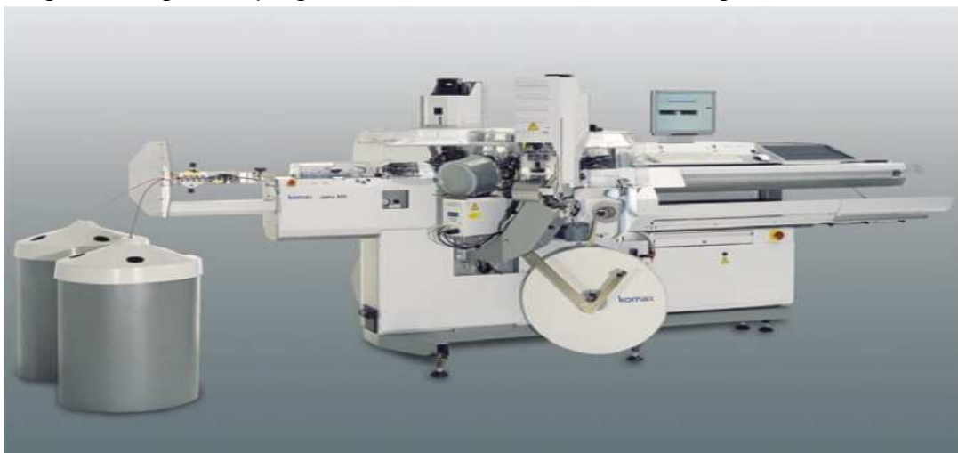
Figure 28: Machine pour sertissage automatique KOMAX ALPHA 355
