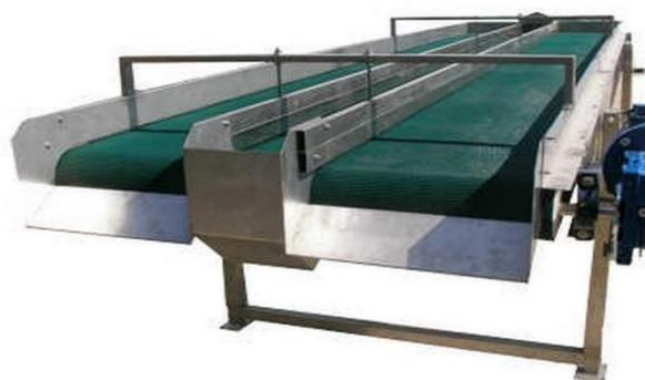
**Figure 12 : Passage par le tapis vibrant et le tapis de triage manuel.**
