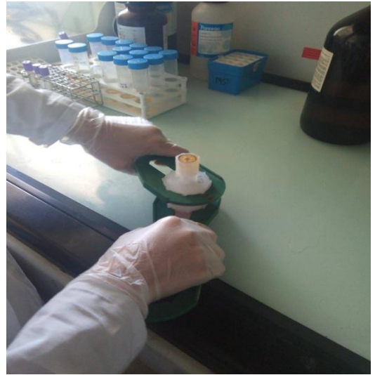
Fermeture des bombes en téflon avec une pince
