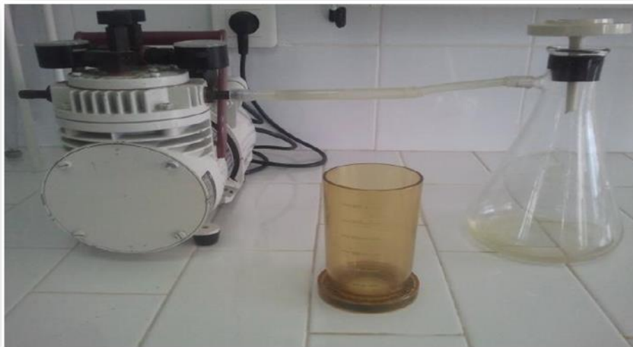
Figure 13 : Filtration de la MES en utilisant une pompe à vide
