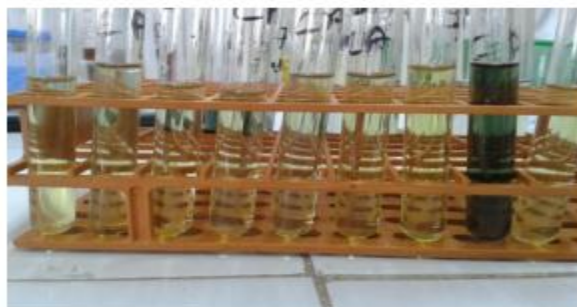
Figure 9 : Solutions à doser après l'ajout de réactif de Folin
