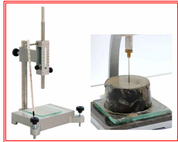
FIGURE 14 : APPAREILLAGE D'ESSAI A AIGUILLE DE VICAT
