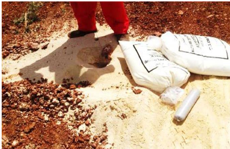
FIGURE 24 : LES PRODUITS D'EXPLOSIF UTILISE PAR LAFARGEHOLCIM (AMMONIX, TOVEX ET AMORCE ELECTRIQUE)
