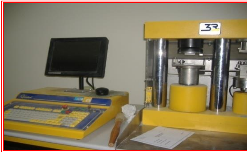
FIGURE 17: APPAREIL IBERTEST (ESSAI DE FLEXION ET COMPRESSION)
