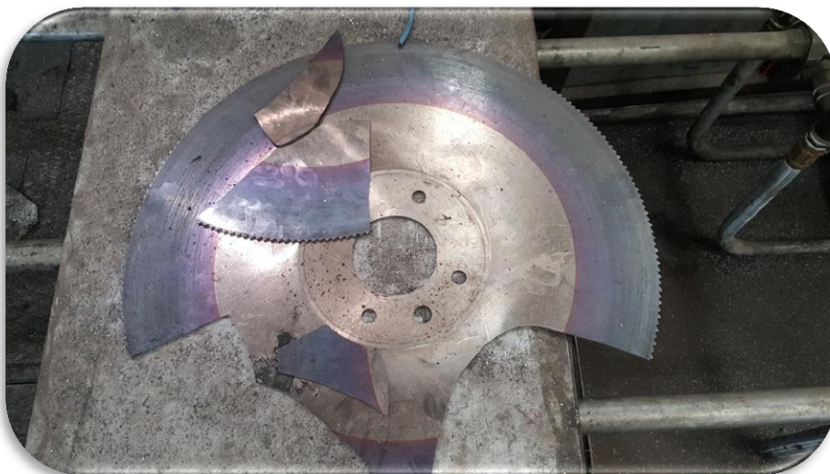
Figure 19 : Rupture du disque de la coupe
