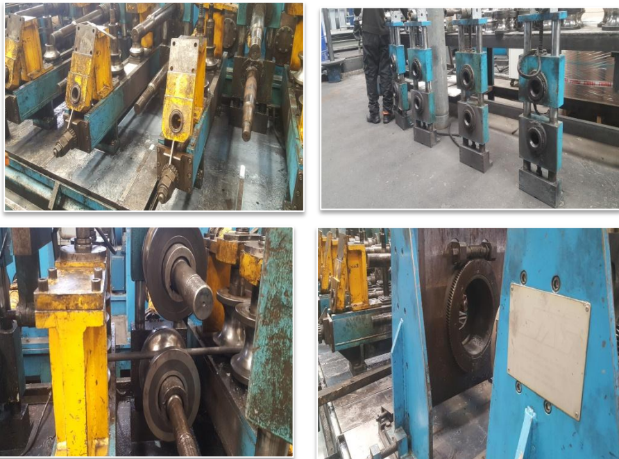
Figure 20 : procédure du changement des galets
