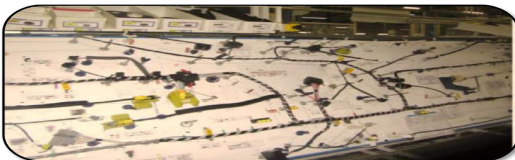
Figure 10 : les tableaux (JIG) de la chaîne de montage
