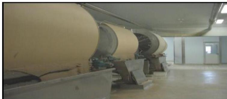
*Figure 10 : filtre rotatif*
